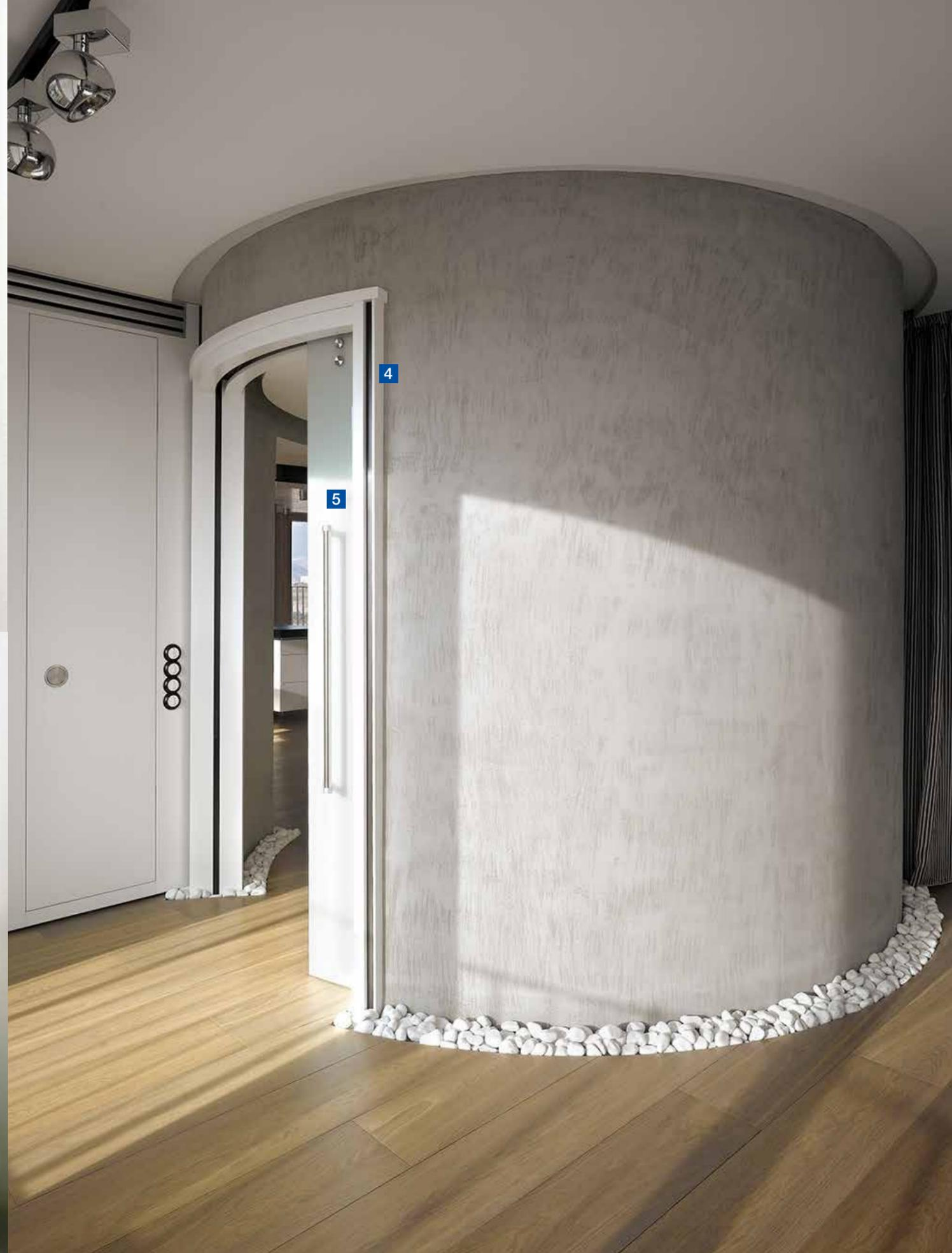
**1** Châssis Novanta pour porte coulissante avec section battante. Épaisseur de cloison : 100 mm. **2** Porte bois coulissante et battante. Largeur de porte : 45 cm (battant) + 41 cm (coulissant). Hauteur de porte : 2,04 m. **3** Poignée Novanta finition chromé satiné.
